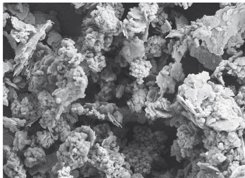
Die Neuburger Kieselerde, die nahe Neuburg an der Donau abgebaut wird, ist ein in der Natur entstandenes Gemisch aus korpuskularer Neuburger Kieselsäure und lamellarem Kaolinit: ein loses Haufwerk, das durch physikalische Methoden nicht zu trennen ist. Der Kieselsäureanteil weist eine runde Kornform auf. Aus diesem Grund besitzt die Kieselsäure keine scharfkantigen Strukturen und zudem wird wegen des geringen Überkornanteils (Grit) ein schonendes Polieren der Oberflächen ermöglicht.
